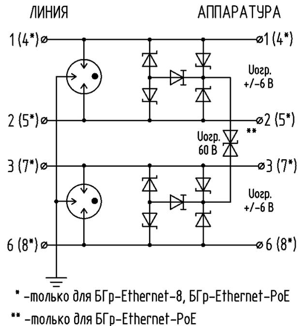
Рисунок 3.2 Электрическая схема
