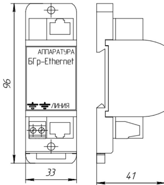
Рисунок 3.1 - УЗИП БГр-Ethernet
